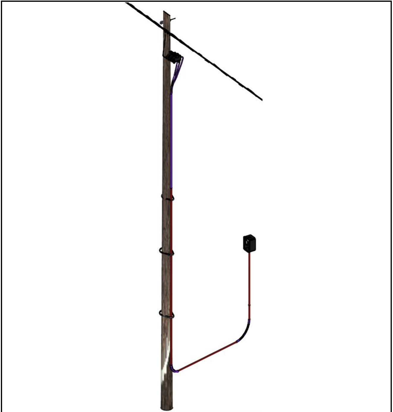
Figura 7: Detalle de la acometida semisubterránea, protección mecánica con caños
