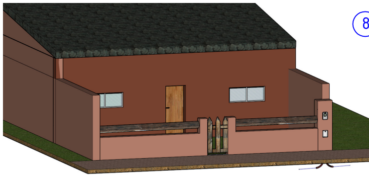
Vista general ejemplo de inmueble con alimentacion subterranea donde LE no coincide con LM
